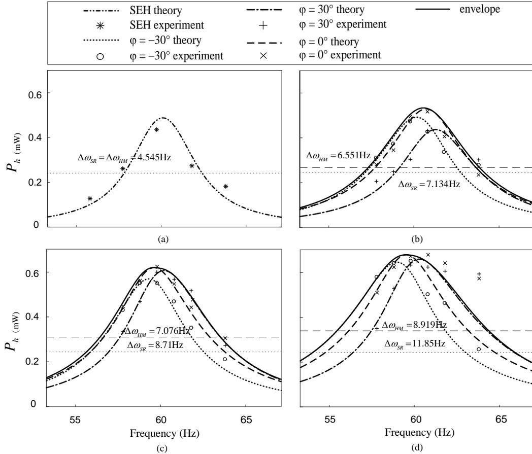
Figure 7. Harvested power  $P_h$ . (a) SEH. (b) PV-S-SSHI. (c) PV-P-SSHI. (d) PV-P-S3BF
