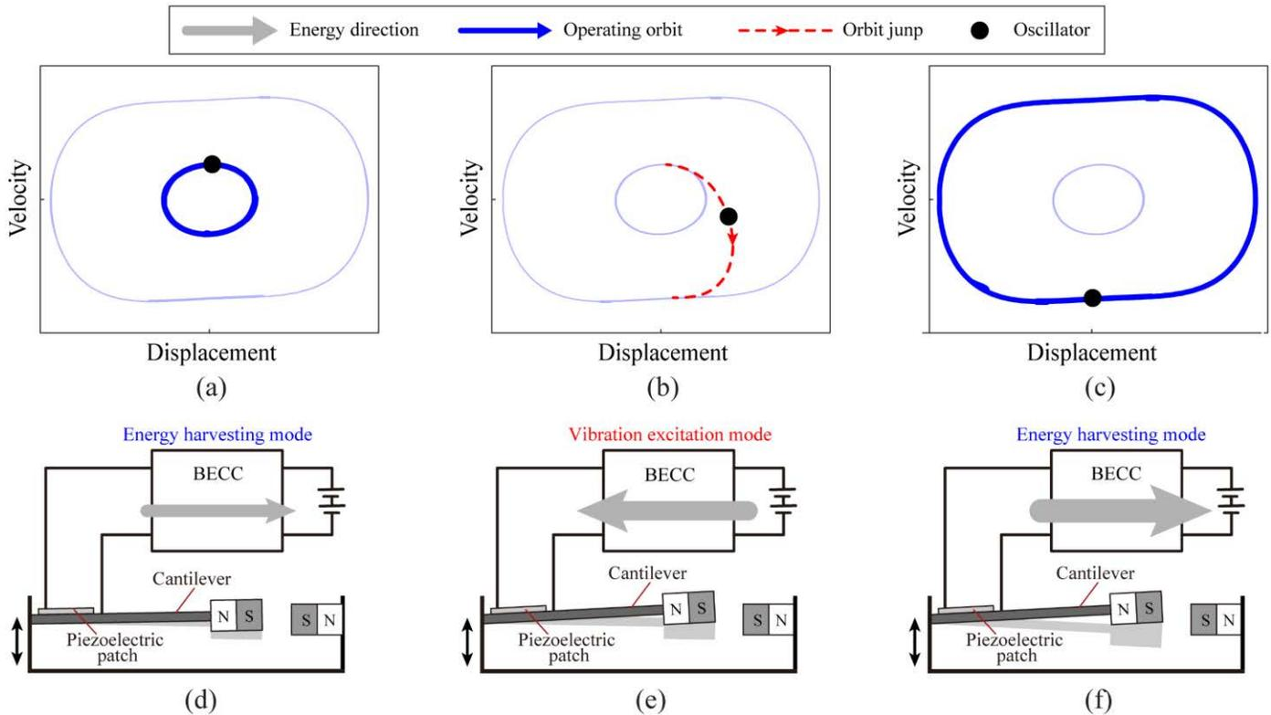
**FIGURE 3: ENERGY HARVESTING AND ORBIT JUMP REALIZED BY THE BECC. (a) AND (d) INITIAL ENERGY HARVESTING MODE AT LOW-ENERGY ORBIT. (b) AND (e) VIBRATION EXCITING MODE FOR ORBIT JUMP. (c) AND (f) ENERGY HARVESTING MODE AT HIGH-ENERGY ORBIT.**
