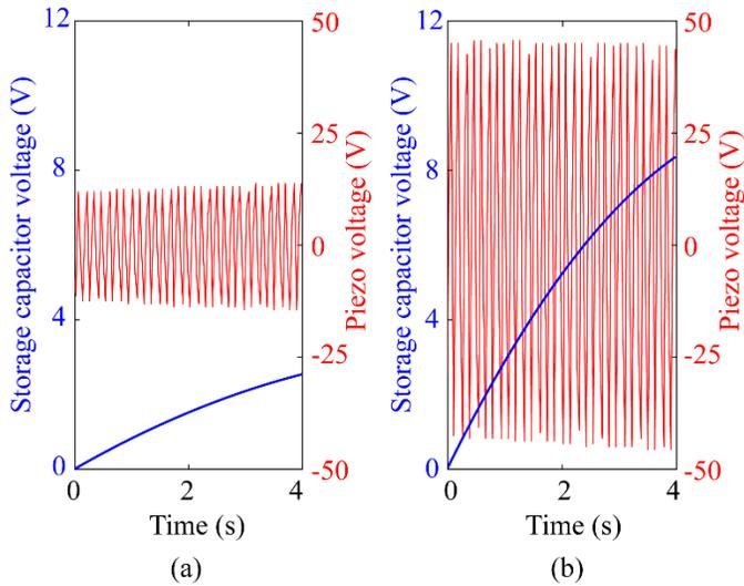
**FIGURE 6:** STORAGE CAPACITOR VOLTAGE AND PIEZOELECTRIC VOLTAGE UNDER ENERGY HARVESTING. (a) THE SYSTEM IS ON THE LOW-ENERGY ORBIT AND (b) THE SYSTEM ON HIGH-ENERGY ORBIT.
