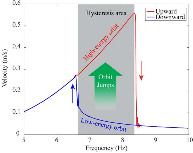
**FIGURE 4:** FREQUENCY SWEEP TEST RESULTS. GRAY REGION SHOWS THE HYSTERESIS AREA. WITHIN THE HYSTERESIS AREA, LOW ENERGY ORBIT AND HIGH-ENERGY ORBIT COEXIST. ACTIONS FROM LOW-ENERGY ORBIT TO HIGH-ENERGY ORBIT IS CALLED ORBIT JUMPS AS THE GREEN ARROW SHOWS.
